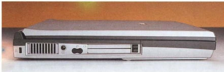
Lato sinistro. Da sinistra, la fessura per il lucchetto di sicurezza a standard Kensington, la griglia di aerazione per il processore, il connettore di alimentazione, la porta IR e gli slot PC-Card, entrambi compatibili ZV.
